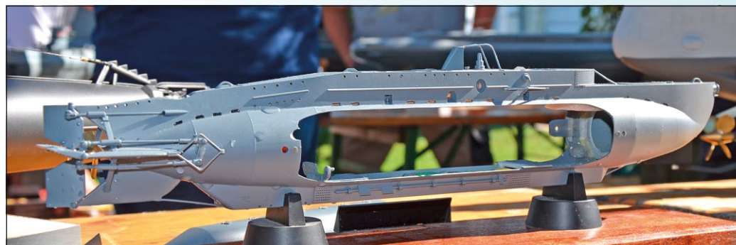
Netradiční koncepce vyjímání těsného trupu z modelu ponorky X Craft
